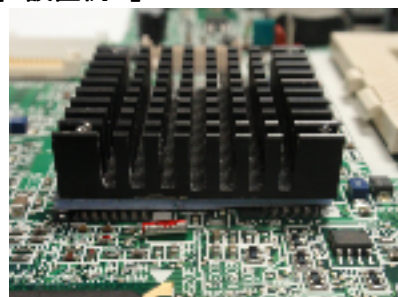
非常に柔らかい素材ですので、装着表面が不均一な複数の部品の接触面をカバーします。
