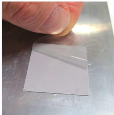
③被着体に貼り付けた後、もう片面のセパレータを剥がします。
